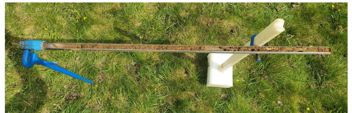
Abbildung des zum Einsatz kommenden "Pürckhauer"-Bohrstock
